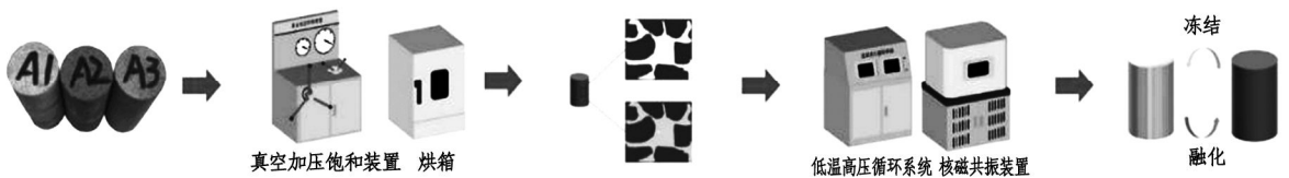
图3 主要试验设备与 NMR 测试流程
