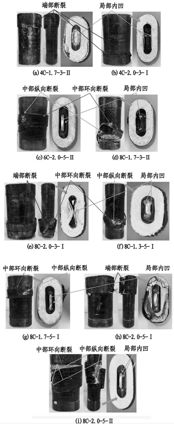
图6 部分典型试件破坏照片
