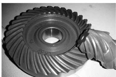
图11 预调整铣齿热处理后前齿轮接触区
