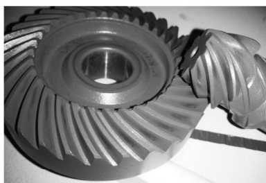
图9 预调整铣齿热处理前齿轮接触区
