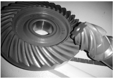
图4 理论铣齿齿面接触区
