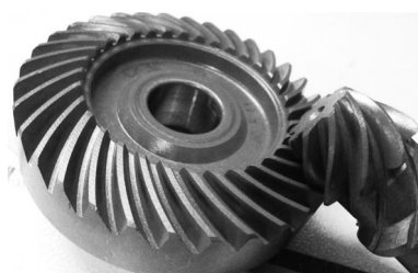
图7 理论铣齿热处理后齿轮接触区
