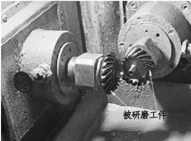
图3 研齿加工示意图
